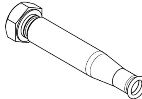
O-Ring mit Montagehilfe bis zur Nut der Schraube schieben, danach die Schraube bis zum Anschlag in die Buchse drücken
