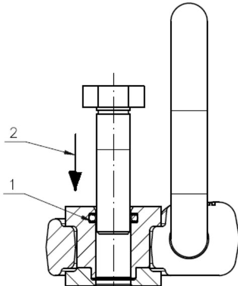
1. O-Ring in die Nut der Buchse stecken
