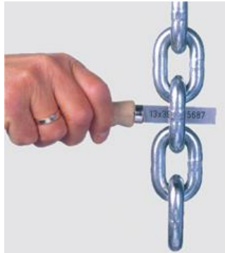
Zustand: Kettenteilung n.i.O.
