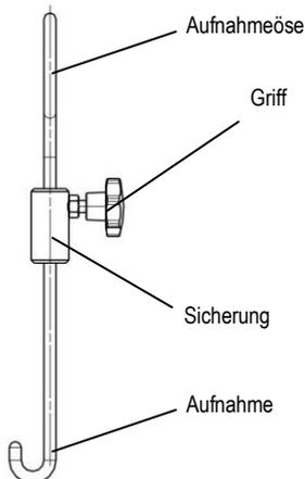
**Bild 1:** Beispiel eines Rundstahlhakens mit Sicherung
