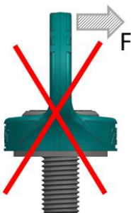
Bild 2: Der Anschlagpunkt darf nicht quer zur Laststrichtung belastet werden.
