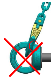
Bild 4: Eine Belastung > 90^\circ ist nicht erlaubt , wenn sich das Anschlagmittel an der Last, oder am Ring Point - Körper, abstützt.
